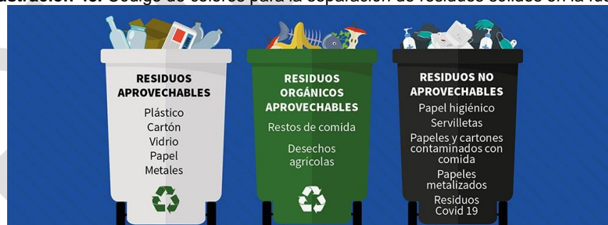
Ilustración 43. Código de colores para la separación de residuos sólidos en la fuente
